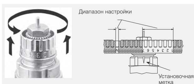
Рис. 4. Предварительная настройка клапана Danfoss
